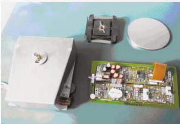
Célula de pesaje WZ224-CW Sartorius con mecanismo de aplicación de pesa interna
