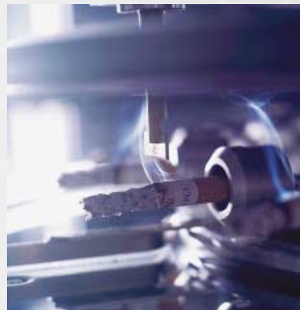
El principio de "rotación" del aro portador de cigarrillos
