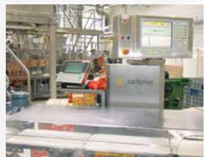
Dans la deuxième ligne de production, une trieuse pondérale EWK contrôle le poids.
