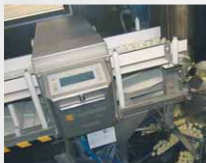
Le détecteur de métaux MDP garantit que les produits qui sont commercialisés ne comprennent aucune impureté métallique.
