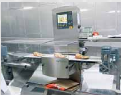
Avec un débit de 100 pièces/min, la trieuse pondérale SYNUS™ contrôle le poids des sachets de boulettes.
